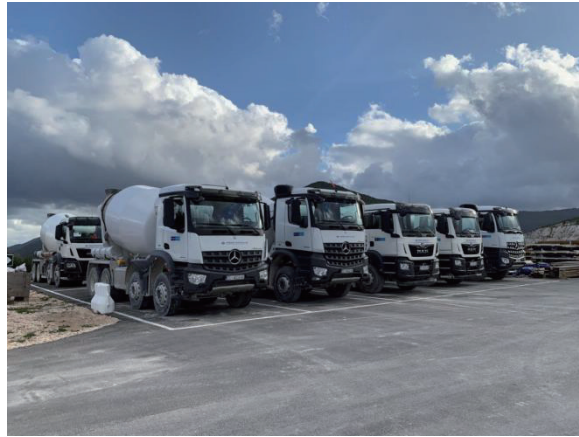
图 39 混凝土罐车停放区域进行沥青罩面防止漏油污染土地
