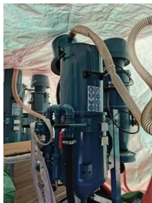
图 37 环保式自吸冲砂设备
